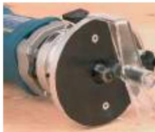
Incorpora un sistema de freno de rodamiento de la fresa, que evita el giro de este al inicio, de forma que no se produzcan marcas accidentales sobre el panel.
