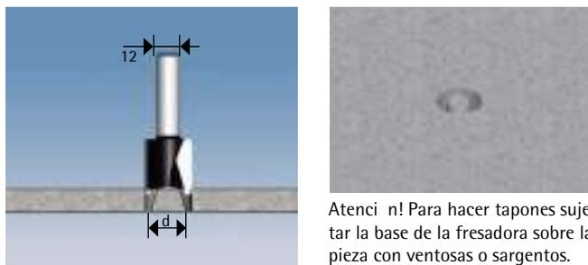
Atención! Para hacer tapones sujetar la base de la fresadora sobre la pieza con ventosas o sargentos.
