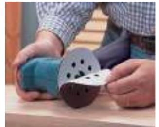
Orificios de aspiración diseñados para permitir la utilización de abrasivos estándar con velcro.
