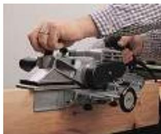
Escuadra micrométrica que permite realizar cepillados inclinados a distintos grados.
