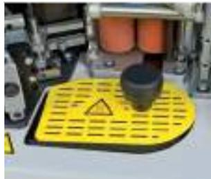
Depósito de cola con tratamiento de polimerización antiadherente. Reducción importante del consumo de cola. Permite el uso de colas PUR termofusibles.
