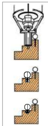
Utilizando la guía a recta: ranuras rectas en rebajo de marcos o ventanas.
