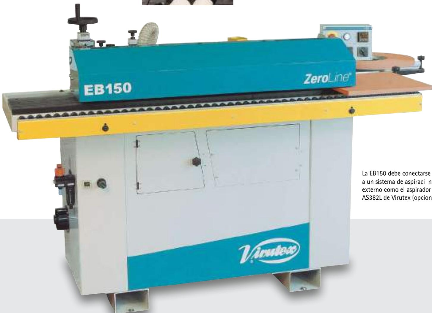
La EB150 debe conectarse a un sistema de aspiración externo como el aspirador AS382L de Virutex (opcional).
