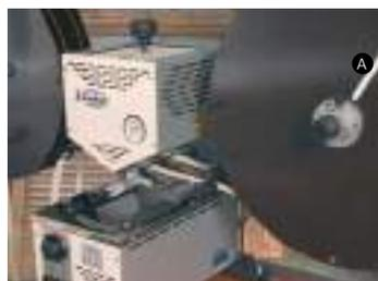
2545628 Devanador automático DV25P. Kit para convertir la PR25VJ manual en una PR25VJ-DV automática.
