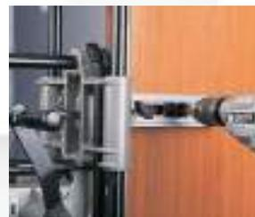
(Incluido en el equipo) usando el til UT16l se obtiene la referencia para taladrar el alojamiento del bomb n y aguja.
