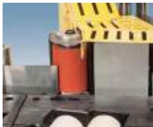
Rodillo de presión motorizado el cual permite obtener un pegado perfecto del canto al principio del tablero. **Sistema patentado**
