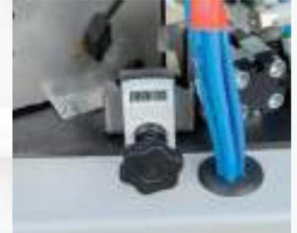
Regulación simultánea con solo un contador digital, para el espesor del canto y las posiciones de la guía de entrada y del rodillo aplicador de cola.
