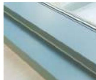
Permite el ranurado de paneles compuestos (Alucobond® y similares) para su posterior doblado seg n necesidades.
