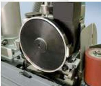
Perfilador de rápida regulación mediante contador digital. Permite el perfilado en bisel o con diferentes radios. Con rascador de doble efecto para un acabado perfecto libre de restos de cola. Retestador automático.
