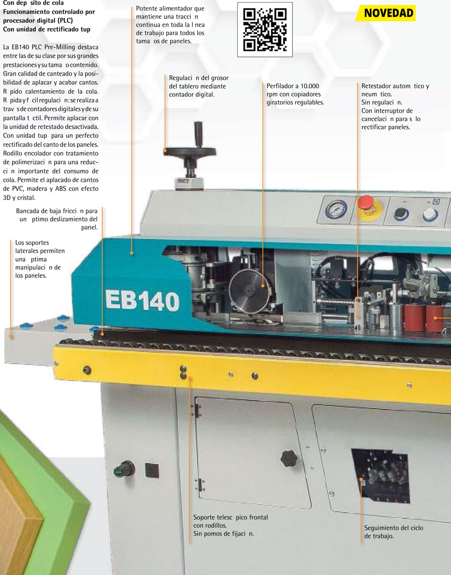
Soporte telescópico frontal con rodillos. Sin pomos de fijación.
