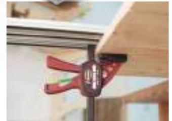
Incluye 2 sargentos que colocados en la gu a inferior sujetan el riel incluso cuando este sobresalga del panel.
