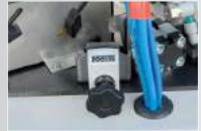
Regulación simultánea de la unidad tup, la unidad de encolado y la selección del grosor del canto mediante un único contador digital.
