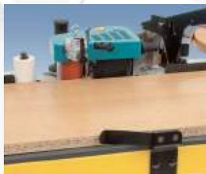
Incorpora guía extensible con prensor para un óptimo apoyo de la pieza a aplacar.
