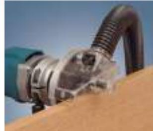
Perfila los cuatro lados del tablero de una sola pasada, con chafn o radio.
