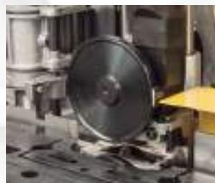
Perfilador de rizada regulable mediante contador digital. Permite el perfilado en bisel o con diferentes radios. Con rascador de doble efecto para un acabado perfecto libre de restos de cola. Retestado automático.
