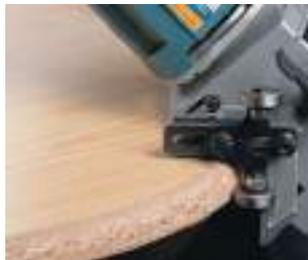
Copiadore de radios opcional. Posibilidad de perfilar el canto en radio (R=5, 10 15), usando las cuchillas de radios ref. 9841005.
