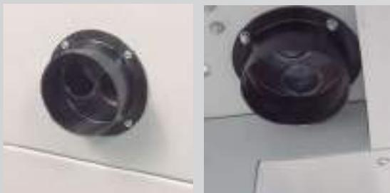
Aspiración centralizada con tomas en toda la línea de trabajo. Dispone de una conexión para 2 tubos de 100 milímetros de diámetro, ideal para sistemas de aspiración externos con un caudal máximo de 1.000 m³/h
