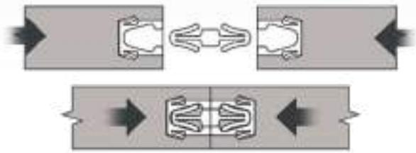
El funcionamiento es sencillo. Simplemente es necesario presionar las dos piezas a ensamblar, encarando los conectores, hasta escuchar un "clic", el cual indica que la unión ha sido realizada.
